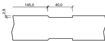
Maße gelten für gefälzte Elemente, bei stumpfen Elementen müssen seitlich und oben 13mm abgezogen werden
