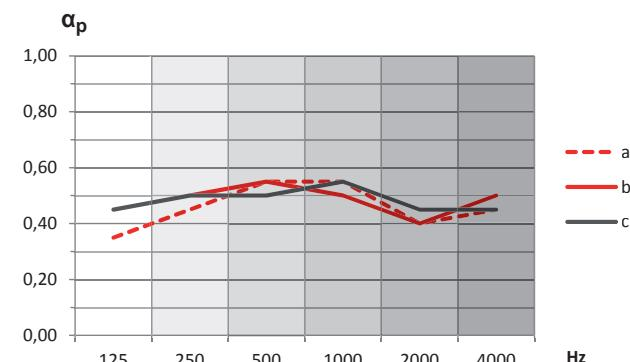
Konstruktionstiefe 65 mm (mit Mineralwollaufage)
