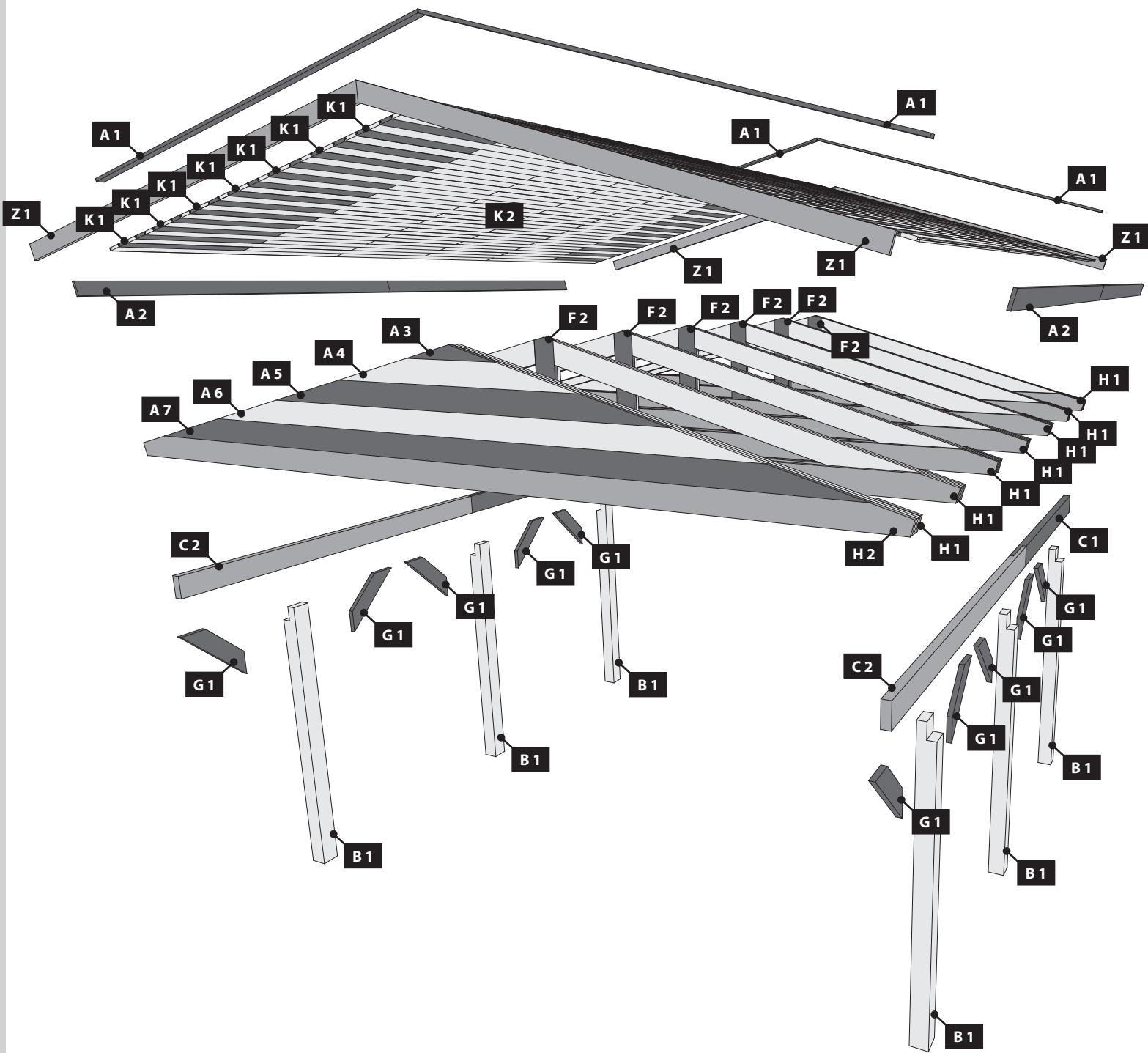
Die Pfosten dieses Produkts sollten fest mit dem Untergrund verbunden werden. Dazu empfehlen wir H-Pfostenanker. Diese sollten erst nach dem Aufbau dieses Produkts endgültig mit Beton versehen werden. Die H-Pfostenanker und das zugehörige Befestigungsmaterial sind nicht im Lieferumfang dieses Produkts enthalten.
