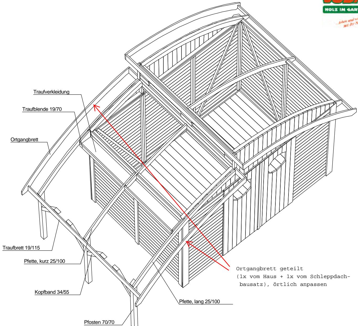
Zuerst sind in Verlängerung der kleinen Giebelelemente, die langen Schleppdachpfetten anzuschrauben. Die Oberkante muß bündig zu den Giebeln sein. Zur Befestigung sind je 8 Spax, 60 mm zu verwenden.
