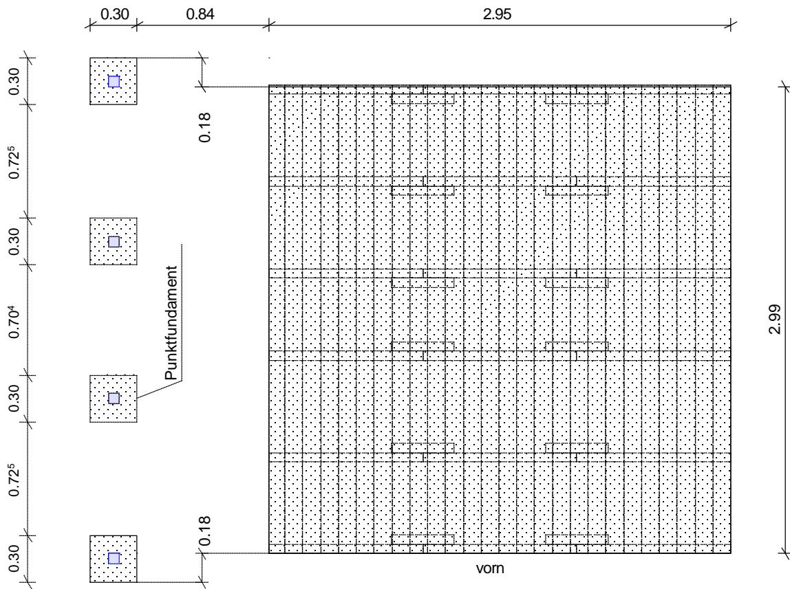
Auf das Fundament ist eine Feuchtesperre (z.B. die Verpackungsfolie oder Grundmauerpappe) aufzubringen.
