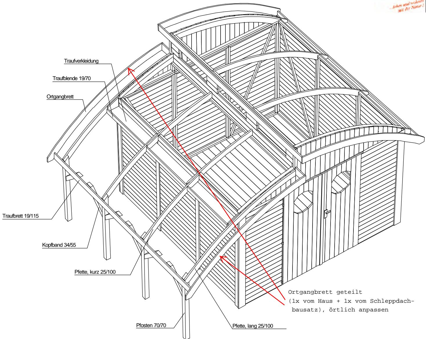
Zuerst sind in Verlängerung der kleinen Giebelelemente, die langen Schleppdachpfetten anzuschrauben. Die Oberkante muß bündig zu den Giebeln sein. Zur Befestigung sind je 8 Spax, 60 mm zu verwenden.
