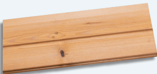
Ausgefallene Äste ohne Durchgangsloch ( < 6\text{mm} )
