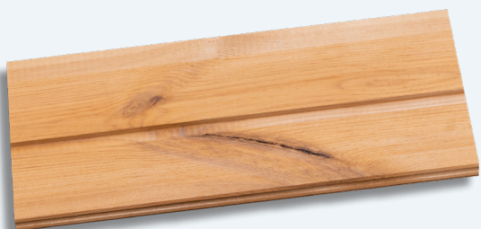
Fest verwachsener Flügelast
