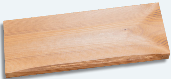
Kleine Kantenschäden bis 30 cm
