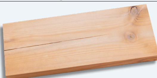
Moderate Endrisse, die sauber geschnitten werden können (max. 10 cm)
