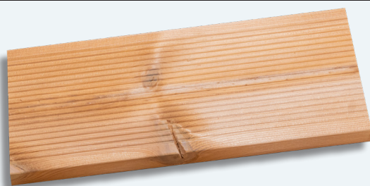
Kantenäste mit Rissen
