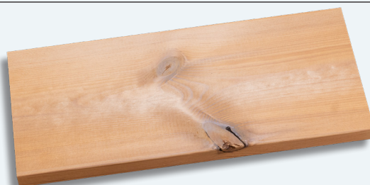
Teilweise fest verwachsene Kantenäste
