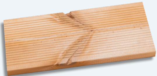
Bretter mit Funktionsbeeinträchtigungen und Bruchgefahr
