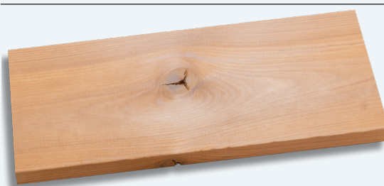
Äste mit sternförmigen Rissen, entstanden durch die Thermobehandlung
