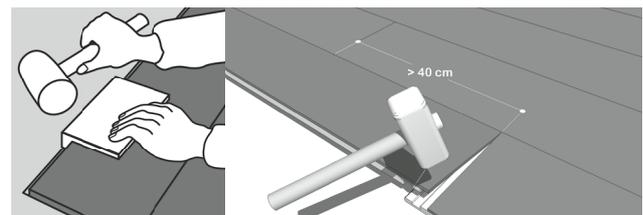
Die Elemente der letzten Reihe werden zugeschnitten und passgenau mit 10 mm Abstand zur Wand eingesetzt.
