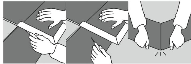
verlegt ist und sichern den 10 mm Wandabstand mit Keilen, auch an den beiden Enden.
