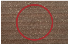
natürlicher Fasereinschluss nach mechanischer Behandlung
