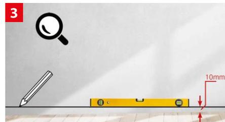
**3** Bei Bodengefälle, müssen Sie die erste Reihe der HQ DekoWall-Dielen zurechtschneiden. Zeichnen Sie sich, mit Hilfe einer Wasserwaage einen Strich an Ihre Wand, um genau beurteilen zu können, wie stark das Gefälle ist. Beginnen Sie an der höchsten Stelle mit 10 mm vom Boden aus. Überprüfen Sie immer den Abstand zur Decke auf Gleichmäßigkeit.
