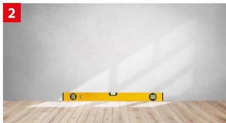
**2** Vorbereitung der Montage. Überprüfen Sie mittels einer Wasserwaage, die Gegebenheiten des Bodens. Bei der Montage der HQ DekoWall muss, ein Sicherheitsabstand von 10 mm, rundum eingehalten werden.
