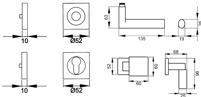
Das Designkonzept des Modells Madeira ER45Q liegt in der Zusammenführung von quadratischen und ovalen Elementen. Gradlinige und schlichte Formen charakterisieren dieses Modell. Durch die 3-teilige Schraubrosette, wird eine einfache, schnelle und sichere Montage gewährleistet. Die Oberfläche Antik Bronze verleiht mit ihrer dunkelbraunen Beschichtung einen warmen Charakter. Durch das Abschleifen der Kanten entstehen feine bronzerfarbene Konturen.
