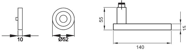
Der Türgriff TORINO R53 hat eine schlichte, rechteckige Handhabe. In die nur wenige Millimeter tiefe Aussparung auf können individuelle Inlays eingeklebt werden. Durch die 3-teilige Schraubrosette, wird eine einfache, schnelle und sichere Montage gewährleistet. Eine edle Optik verleiht die Farbe Nickel matt, welche durch die Brüstung besonders charakterisiert wird.
