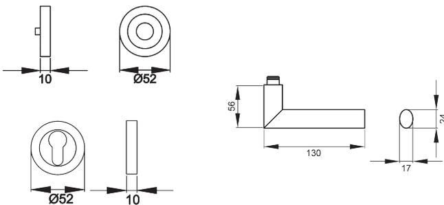
Der Türgriff Verona ER37 zeichnet sich durch sanftere und fließende Konturen aus, was durch den ovalen Hals unterstützt wird. Durch die 3-teilige Schraubrosette, wird eine einfache, schnelle und sichere Montage gewährleistet. Die mehrfach prämierte seidenweiche Oberfläche Kosmos Schwarz, schafft eine unvergessliche Haptik.
