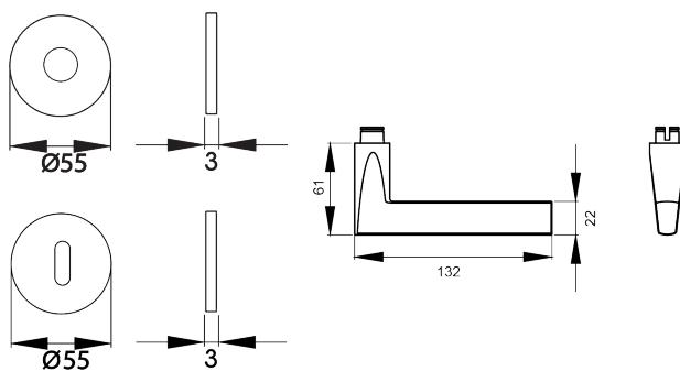
Hochwertiger Edelstahl und eine vollkommene Formsprache verleihen dem Türgriff Montana EPL54 eine hervorragende Handhabe. Die Reduktion auf geometrische Formen lassen den Türgriff elegant und zeitlos wirken. In Kombination mit der 3mm dünnen Plan Design Rosette, ist eine aufgesetzte oder flächenbündige Montage möglich. Die Farbe Titan Grau überzeugt durch seine matte Oberfläche und warm-graue Farbigkeit.
