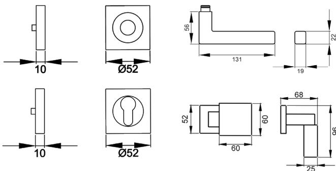
Quadratisch, schlicht und geradlinig ist das Designkonzept des Modells ER46Q. Rational und minimalistisch folgt dieser Griff dem Trend zu geraden Linien. Durch die 3-teilige Schraubrossette, wird eine einfache, schnelle und sichere Montage gewährleistet. Die Oberfläche Antik Bronze verleiht mit ihrer dunkelbraunen Beschichtung einen warmen Charakter. Durch das Abschleifen der Kanten entstehen feine bronzefarbene Konturen.
