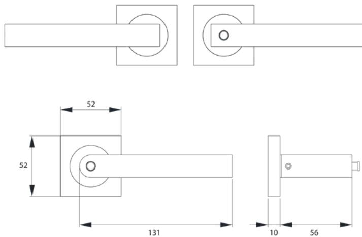
Quadratisch, schlicht und geradlinig ist das Designkonzept des Models ER46Q. Rational und minimalistisch folgt dieser Griff dem Trend zu geraden Linien. Durch einen Pin auf dem Türgriff selbst, ist das Verschließen Ihrer Türen ohne Bad- oder Schlüsselrosette möglich. Die Farbe Titan Grau überzeugt durch seine matte Oberfläche und warm-graue Farbigkeit.
