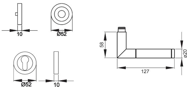
Der Türgriff Rio Steel ER34 besitzt eine runde Handhabe, welche optisch durch zwei Vertiefungen nochmals unterteilt ist. Durch die 3-teilige Schraubrosette, wird eine einfache, schnelle und sichere Montage gewährleistet. Die edelstahlmatten Farbe unterstreicht die Formgebung dieses Griffs.
