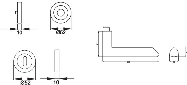
Das Modell PARIS ER55 kombiniert Ergonomie und Design auf höchstem Niveau. Das Highlight ist das abgeschrägte Ende, welches durch eine klar definierte Kante in zwei unterschiedliche Formelemente unterteilt wird. Durch die 3-teilige Schraubrosette, wird eine einfache, schnelle und sichere Montage gewährleistet. Die mehrfach prämierte seidenweiche Oberfläche Kosmos Schwarz, schafft eine unvergessliche Haptik.
