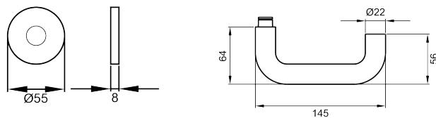
Der Türgriff Kreta XL EPRO17 hat eine zur Tür laufende Handhabe mit abgerundeten Ecken und ist somit ebenfalls für Notausgangstüren geeignet. Montiert auf der Performance Rosette, ist die EPR Technik DIE Lösung für robuste und starke Beanspruchung im Objektbereich. Die edelstahlmatte Farbe unterstreicht die Formgebung dieses Griffes.
