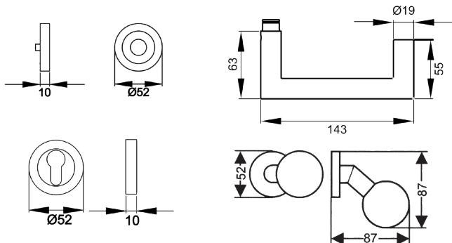
Angelehnt an das Modell Rhodos, besitzt der Türgriff Kos ER20 eine zur Tür laufende Handhabe und ist somit ebenfalls für Notausgangstüren geeignet. Durch die 3-teilige Schraubrosette, wird eine einfache, schnelle und sichere Montage gewährleistet. Die edelstahlmatte Farbe unterstreicht die Formgebung dieses Griffs.
