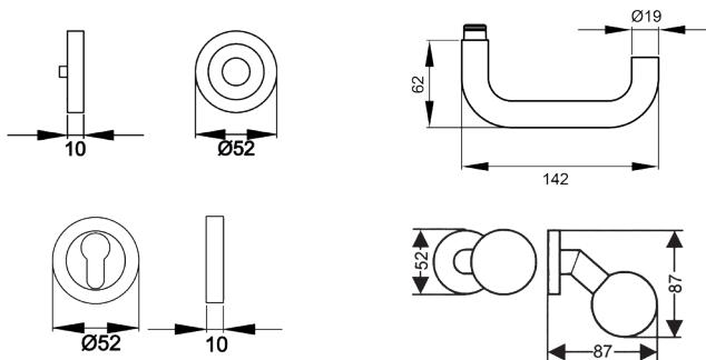
Der Türgriff Kreta ER27 hat eine zur Tür laufende Handhabe mit abgerundeten Ecken und ist somit ebenfalls für Notausgangstüren geeignet. Durch die 3-teilige Schraubrosette, wird eine einfache, schnelle und sichere Montage gewährleistet. Die edelstahlmatte Farbe unterstreicht die Formgebung dieses Griffs.
