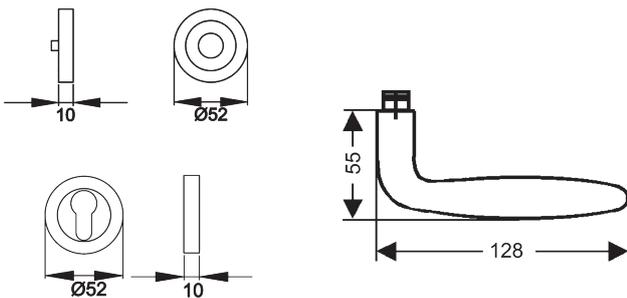
Mit seinem oval förmigen Griffende ist der Türgriff Korfu ER24 ein echter Komfort für die Hand. Durch die 3-teilige Schraubrossette, wird eine einfache, schnelle und sichere Montage gewährleistet. Die mehrfach prämierte seidenweiche Oberfläche Kosmos Schwarz, schafft eine unvergessliche Haptik.
