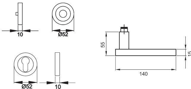
Der Türgriff TORINO R53 hat eine schlichte, rechteckige Handhabe. In die nur wenige Millimeter tiefe Aussparung auf können individuelle Inlays eingeklebt werden. Durch die 3-teilige Schraubrosette, wird eine einfache, schnelle und sichere Montage gewährleistet. Eine edle Optik verleiht die Farbe Nickel matt, welche durch die Brüstung besonders charakterisiert wird.
