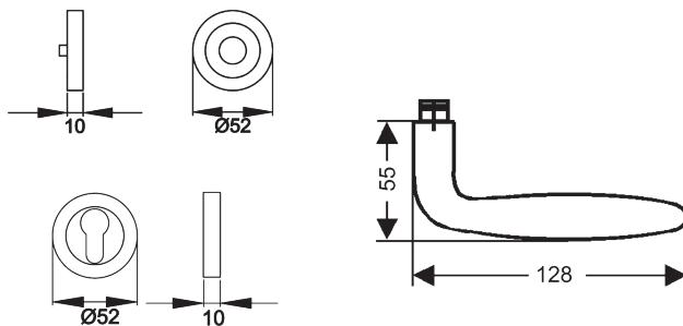
Mit seinem oval förmigen Griffende ist der Türgriff Korfu ER24 ein echter Komfort für die Hand. Durch die 3-teilige Schraubrosette, wird eine einfache, schnelle und sichere Montage gewährleistet. Die edelstahlmatte Farbe unterstreicht die Formgebung dieses Griffs.
