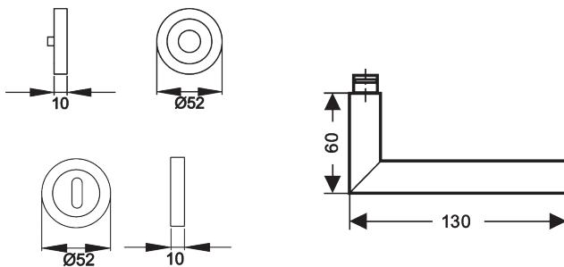
Der schlicht und einfache wirkende Türgriff ER29 überrascht mit seinem abgeflachten und leicht abgeschrägten Griffende, wodurch ihm eine besonders moderne Note verliehen wird. Durch die 3-teilige Schraubrosette, wird eine einfache, schnelle und sichere Montage gewährleistet. Die edelstahlmatte Farbe unterstreicht die Formgebung dieses Griffs.
