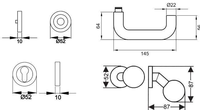
Der Türgriff Kreta XL ER17 hat eine zur Tür laufende Handhabe mit abgerundeten Ecken und ist somit ebenfalls für Notausgangstüren geeignet. Durch die 3-teilige Schraubrosette, wird eine einfache, schnelle und sichere Montage gewährleistet. Die edelstahlmatte Farbe unterstreicht die Formgebung dieses Griffs.
