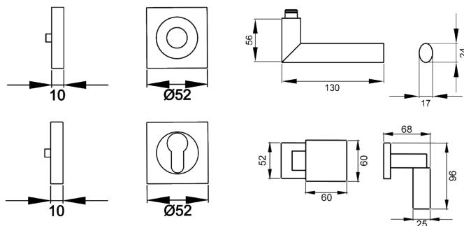
Der Türgriff Verona ER37Q zeichnet sich durch sanftere und fließende Konturen aus, was durch den ovalen Hals unterstützt wird. Durch die 3-teilige Schraubrosette, wird eine einfache, schnelle und sichere Montage gewährleistet. Mit der hochwertigen Farbe Edelstahl matt/ poliert trifft zeitlose Eleganz auf edle Optik.
