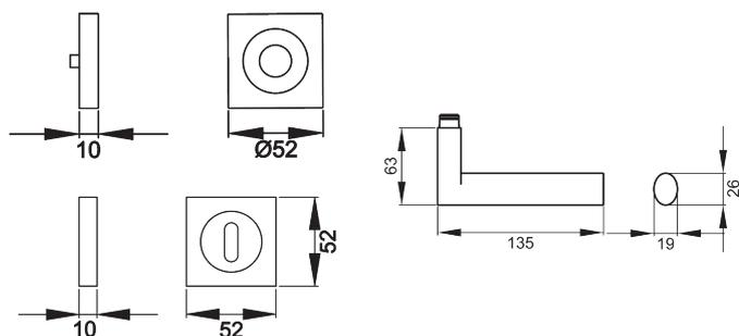
Das Designkonzept des Modells Madeira ER45Q liegt in der Zusammenführung von quadratischen und ovalen Elementen. Gradlinige und schlichte Formen charakterisieren dieses Modell. Durch die 3-teilige Schraubrosette, wird eine einfache, schnelle und sichere Montage gewährleistet. Die Oberfläche Antik Bronze verleiht mit ihrer dunkelbraunen Beschichtung einen warmen Charakter. Durch das Abschleifen der Kanten entstehen feine bronzefarbene Konturen.
