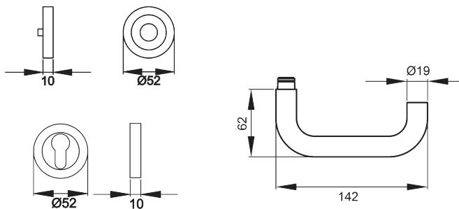
Der Türgriff Kreta ER27 hat eine zur Tür laufende Handhabe mit abgerundeten Ecken und ist somit ebenfalls für Notausgangstüren geeignet. Durch die 3-teilige Schraubrose, wird eine einfache, schnelle und sichere Montage gewährleistet. Die edelstahlmatte Farbe unterstreicht die Formgebung dieses Griffs.
