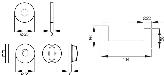
Angelehnt an das Modell Rhodos, besitzt der Türgriff Kos XL EPRO10 eine zur Tür laufende Handhabe und ist somit ebenfalls für Notausgangstüren geeignet. Montiert auf der Performance Rosette, ist die EPR Technik DIE Lösung für robuste und starke Beanspruchung im Objektbereich. Die edelstahlmatte Farbe unterstreicht die Formgebung dieses Griffs.
