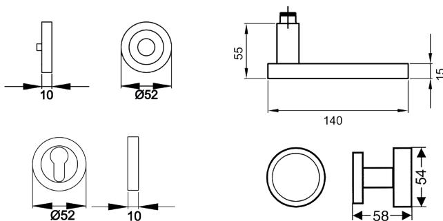
Der Türgriff TORINO R53 hat eine schlichte, rechteckige Handhabe. In die nur wenige Millimeter tiefe Aussparung auf können individuelle Insets eingeklebt werden. Durch die 3-teilige Schraubrosette, wird eine einfache, schnelle und sichere Montage gewährleistet. Eine edle Optik verleiht die Farbe Nickel matt, welche durch die Brüstung besonders charakterisiert wird.
