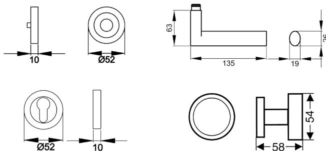
Das Designkonzept des Modells Madeira ER45 liegt in der Zusammenführung von quadratischen und ovalen Elementen. Gradlinige und schlichte Formen charakterisieren dieses Modell. Durch die 3-teilige Schraubrosette, wird eine einfache, schnelle und sichere Montage gewährleistet. Die mehrfach prämierte seidenweiche Oberfläche Kosmos Schwarz, schafft eine unvergessliche Haptik.
