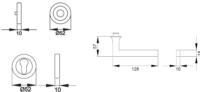
Beim Modell Soho ER57 werden klare Kanten durch gerundete Elemente aufgelöst. Dieses ausgewogene Formenspiel lässt den Türgriff ergonomisch in der Hand liegen. Durch die 3-teilige Schraubrosette, wird eine einfache, schnelle und sichere Montage gewährleistet. Die mehrfach prämierte seidenweiche Oberfläche Kosmos Schwarz, schafft eine unvergessliche Haptik.
