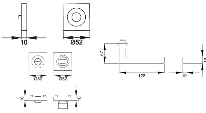
Beim Modell Soho ER57Q werden klare Kanten durch gerundete Elemente aufgelöst. Dieses ausgewogene Formenspiel lässt den Türgriff ergonomisch in der Hand liegen. Durch die 3-teilige Schraubrosette, wird eine einfache, schnelle und sichere Montage gewährleistet. Die edelstahlmatte Farbe unterstreicht die Formgebung dieses Griffs.
