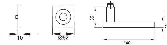
Der Türgriff TORINO R53Q hat eine schlichte, rechteckige Handhabe. In die nur wenige Millimeter tiefe Aussparung auf können individuelle Inlays eingeklebt werden. Durch die 3-teilige Schraubrosette, wird eine einfache, schnelle und sichere Montage gewährleistet. Die mehrfach prämierte seidenweiche Oberfläche Kosmos Schwarz, schafft eine unvergessliche Haptik.
