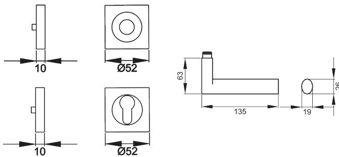
Das Designkonzept des Modells Madeira ER45Q liegt in der Zusammenführung von quadratischen und ovalen Elementen. Gradlinige und schlichte Formen charakterisieren dieses Modell. Durch die 3-teilige Schraubrosette, wird eine einfache, schnelle und sichere Montage gewährleistet. Die mehrfach prämierte seidenweiche Oberfläche Kosmos Schwarz, schafft eine unvergessliche Haptik.
