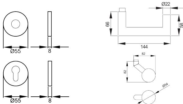
Angelehnt an das Modell Rhodos, besitzt der Türgriff Kos XL EPRO10 eine zur Tür laufende Handhabe und ist somit ebenfalls für Notausgangstüren geeignet. Montiert auf der Performance Rosette, ist die EPR Technik DIE Lösung für robuste und starke Beanspruchung im Objektbereich. Die edelstahlmatte Farbe unterstreicht die Formgebung dieses Griffs.
