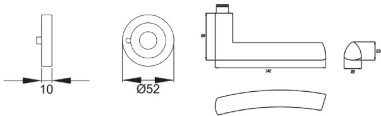
Das Modell Madrid ER56 ist durch seine trigonometrische Form perfekt an die menschliche Hand angepasst. Das Türgrif fende ist ein wohl geformtes und gleichmäßig abgeflachtes Dreieck In Kombination mit der KD Comfort Ausführung, ist das Schließen Ihre Türen ohne Bad oder Schlüsselrosette möglich. Die edelstahlmatte Farbe unterstreicht die Formgebung dieses Griffs.
