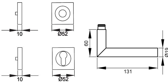
Das Modell Rhodos ER28Q ist der Klassiker schlechthin. Durch seine Geometrische Form, ist das Modell der Bestseller unter den Türgriffen. Durch die 3-teilige Schraubrosette, wird eine einfache, schnelle und sichere Montage gewährleistet. Die edelstahlmatte Farbe unterstreicht die Formgebung dieses Griffs.
