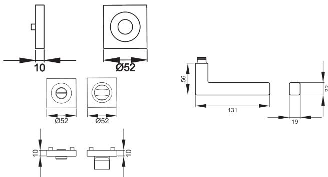
Quadratisch, schlicht und geradlinig ist das Designkonzept des Models ER46Q. Rational und minimalistisch folgt dieser Griff dem Trend zu geraden Linien. Durch die 3-teilige Schraubrosette, wird eine einfache, schnelle und sichere Montage gewährleistet. Die Farbe Titan Grau überzeugt durch seine matte Oberfläche und warm-graue Farbigkeit.
