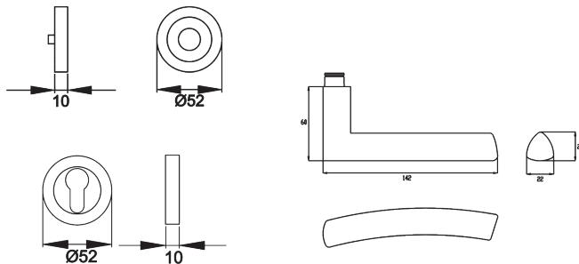
Das Modell Madrid ER56 ist durch seine trigonometrische Form perfekt an die menschliche Hand angepasst. Das Türgriffende ist ein wohl geformtes und gleichmäßig abgeflachtes Dreieck. Durch die 3-teilige Schraubrosette, wird eine einfache, schnelle und sichere Montage gewährleistet. Die edelstahlmatte Farbe unterstreicht die Formgebung dieses Griffs.
