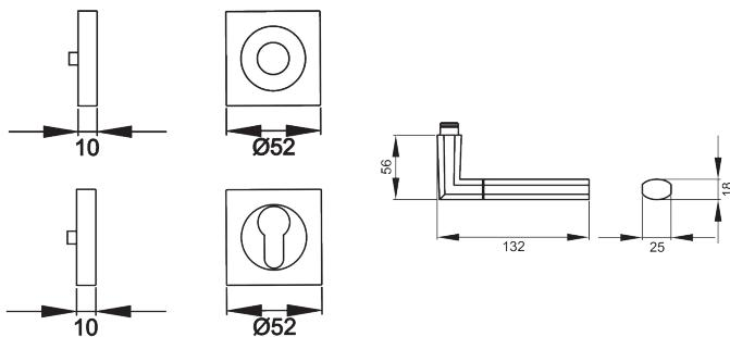
Charakteristisch für das Türgriff Modell Oregon ER48Q ist breite und ovale Form. Optisch zweigeteilt, liegt das Modell besonders gut in der Hand. Durch die 3-teilige Schraubrosette, wird eine einfache, schnelle und sichere Montage gewährleistet. Die edelstahlmatte Farbe unterstreicht die Formgebung dieses Griffs.
