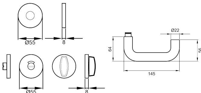
Der Türgriff Kreta XL EPRO17 hat eine zur Tür laufende Handhabe mit abgerundeten Ecken und ist somit ebenfalls für Notausgangstüren geeignet. Montiert auf der Performance Rosette, ist die EPR Technik DIE Lösung für robuste und starke Beanspruchung im Objektbereich. Die edelstahlmatte Farbe unterstreicht die Formgebung dieses Griffes.
