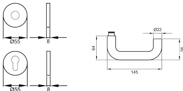
Der Türgriff Kreta XL EPRO17 hat eine zur Tür laufende Handhabe mit abgerundeten Ecken und ist somit ebenfalls für Notausgangstüren geeignet. Montiert auf der Performance Rosette, ist die EPR Technik DIE Lösung für robuste und starke Beanspruchung im Objektbereich. Die edelstahlmatte Farbe unterstreicht die Formgebung dieses Griffes.
