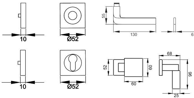
Der Türgriff Las Vegas ER87Q ist nach oben gebogen, durch klare Rundungen und eine stromlinienförmige Form definiert. Zum Griffende hin verläuft er flach. Durch die 3-teilige Schraubrosette, wird eine einfache, schnelle und sichere Montage gewährleistet. Die Oberfläche in Edelstahl poliert verleiht eine elegante Optik aus hochwertigem Edelstahl.
