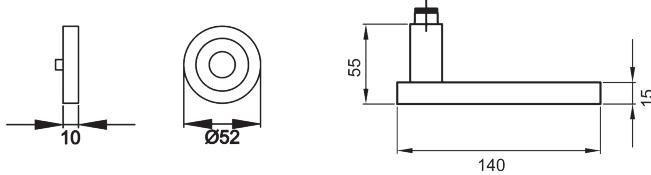
Der Türgriff TORINO R53 hat eine schlichte, rechteckige Handhabe. In die nur wenige Millimeter tiefe Aussparung auf können individuelle Inlays eingeklebt werden. Durch die 3-teilige Schraubrosette, wird eine einfache, schnelle und sichere Montage gewährleistet. Die mehrfach prämierte seidenweiche Oberfläche Kosmos Schwarz, schafft eine unvergessliche Haptik.
