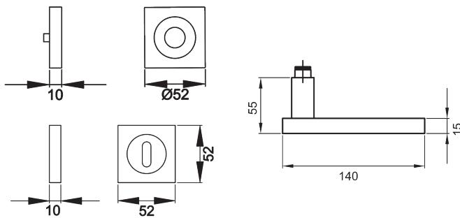
Der Türgriff TORINO R53Q hat eine schlichte, rechteckige Handhabe. In die nur wenige Millimeter tiefe Aussparung auf können individuelle Insets eingeklebt werden. Durch die 3-teilige Schraubrosette, wird eine einfache, schnelle und sichere Montage gewährleistet. Eine edle Optik verleiht die Farbe Nickelmatt, welche durch die Brüstung besonders charakterisiert wird.
