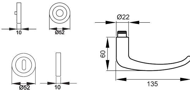
Ohne Ecken und Kanten. Der Türgriff Elba ER22 passt sich durch seine abgerundete Form der Handinnenseite an und verschafft so eine angenehme Haptik. Durch die 3-teilige Schraubrosette, wird eine einfache, schnelle und sichere Montage gewährleistet. Die edelstahlmatte Farbe unterstreicht die Formgebung dieses Griffs.
