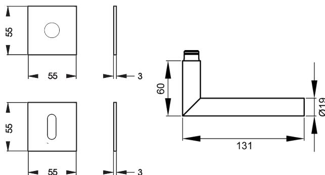
Das Modell Rhodos EPL28Q ist der Klassiker schlechthin. Durch seine Geometrische Form, ist das Modell der Bestseller unter den Türgriffen. In Kombination mit der 3 mm dünnen Plan Design Rosette, werden fließende Übergänge und Ästhetik vereint. Die mehrfach prämierte seidenweiche Oberfläche Kosmos Schwarz, schafft eine unvergessliche Haptik.
