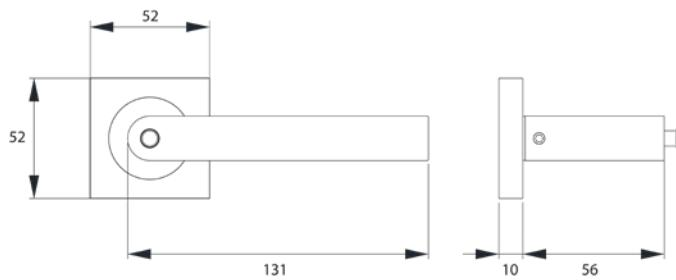
Quadratisch, schlicht und geradlinig ist das Designkonzept des Models ER46Q. Rational und minimalistisch folgt dieser Griff dem Trend zu geraden Linien. Durch einen Pin auf dem Türgriff selbst, ist das Verschließen Ihrer Türen ohne Bad- oder Schlüsselrosette möglich. Die mehrfach prämierte seidenweiche Oberfläche Kosmos Schwarz, schafft eine unvergessliche Haptik.
