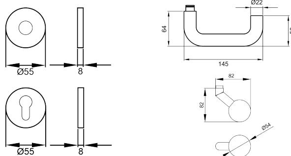
Der Türgriff Kreta XL EPRO17 hat eine zur Tür laufende Handhabe mit abgerundeten Ecken und ist somit ebenfalls für Notausgangstüren geeignet. Montiert auf der Performance Rosette, ist die EPR Technik DIE Lösung für robuste und starke Beanspruchung im Objektbereich. Die edelstahlmatte Farbe unterstreicht die Formgebung dieses Griffes.
